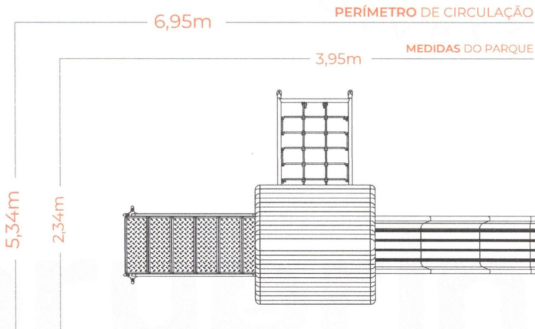
01 Plataforma (A=1,35m) c/ cobertura em polietileno rotomoldado.
