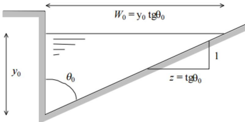
Figura 2 - Corte lateral de uma sarjeta. Fonte: (Pompêo, 2001).
